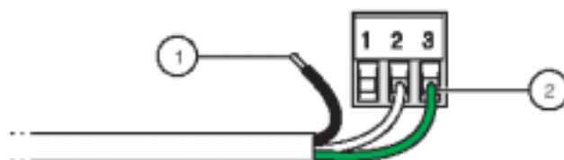
图 3-13 正确的导线制作及插入
